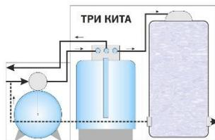
Система отопления - **2-х трубная, разводка пропиленовых трубопроводов горизонтальная. Система обеспечивается от напольного дизельного котла:**
