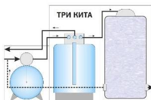
Установка обратного осмоса. **Умягчение жёсткой воды, максимальная очистка воды для мойки автомобиля без разводов, обеспечивает хорошую работу автошампуня:**
