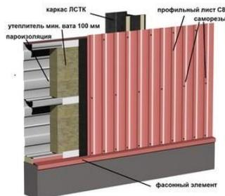
Комплект фасонных элементов – **доборные элементы и нащельники, выполненные из гладкого металла**. Окраска по порошковой технологии в любой цвет. Установка элементов на:
