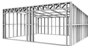
Наружная обшивка каркаса - профильный лист с двух сторон с минераловатным утеплителем 100 мм и пароизоляцией в два слоя.
