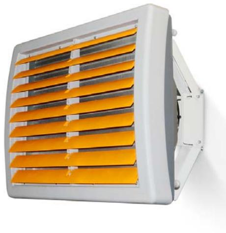
**Тепловентилятор** для отопления офисных, административных, складских, промышленных и других помещений. Монтаж — вертикальный или горизонтальный. Монтажный кронштейн с регулируемыми углами поворота и наклона тепловентилятора, и регулируемые жалюзи позволяют направить воздушную струю в рабочую область.
